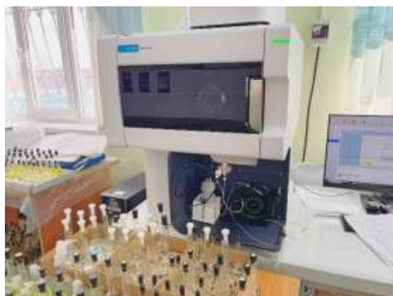
Опτικο-эмиссионный спектрометр ИСП Agilent 5900 способен одновременно анализировать многоэлементный состав исследуемой пробы.
